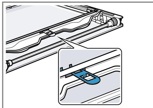
3. Die Innenscheibe schräg nach hinten in die Befestigungsschiene **a** einsetzen **1**.
