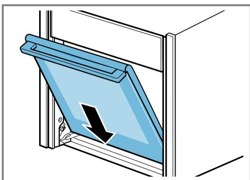
3. Mit einer Münze die beiden Arretierungen der Gerätetür lösen. Die Münze in den Spalt der Arretierung stecken
