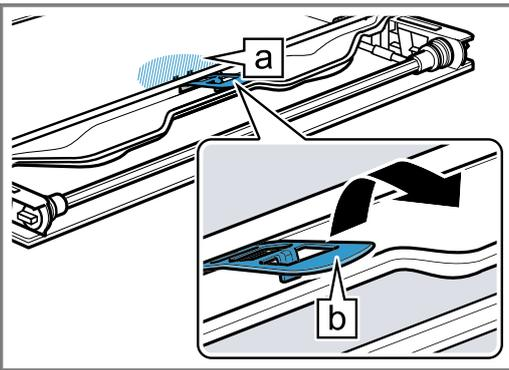
5. Die Zwischenscheibe von unten anheben **1** und in Pfeilrichtung herausnehmen **2**.
