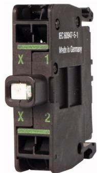
**Leuchtelement, LED, grün, Bodenbefestigung, 12 - 30 V AC/DC, Federzuganschluss**
